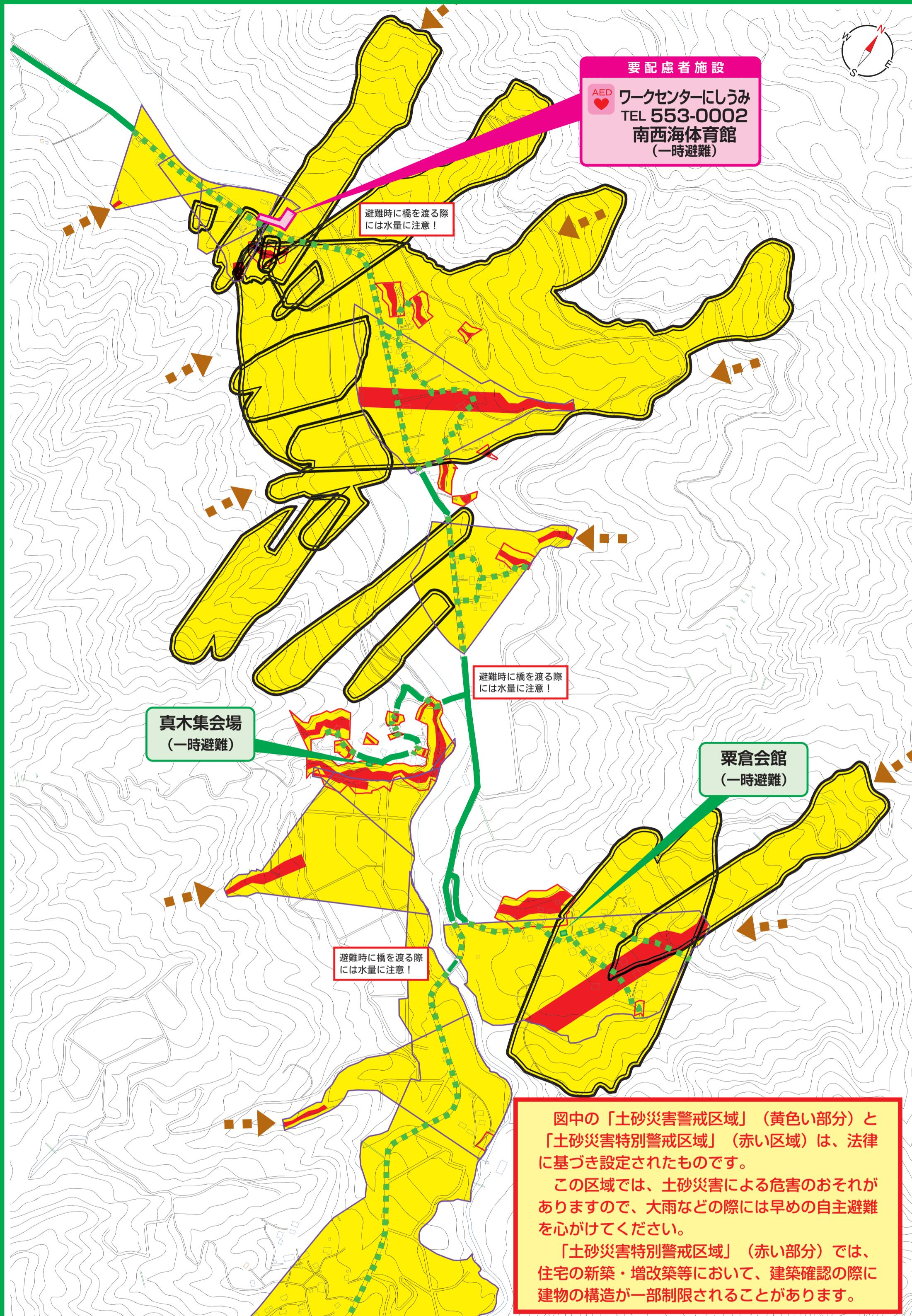
図中の「土砂災害警戒区域」(黄色い部分)と「土砂災害特別警戒区域」(赤い区域)は、法律に基づき設定されたものです。
